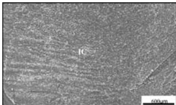
FIGURA 7 – Fotomicrografia da interface de fratura submetida ao cisalhamento: In Ceram Alumina/ Vitadur Alfa
