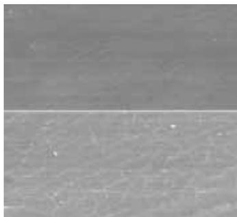
**FIGURA 2** superfície da porcelana com vitrificação. Aumento de 100x (quadro superior) e 500x (quadro inferior).
